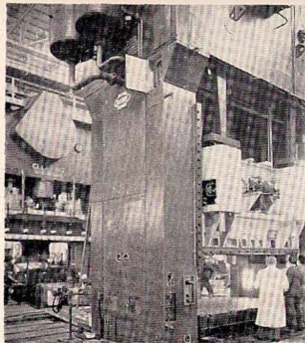
Une des presses installées aux usines Beeliet pour la fabrication des cabines de camions. Cliché D. L.
